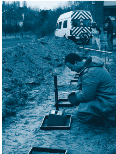
meting van dichtheid en watergehalte d.m.v. een nucleaire dichtheidsmeter
